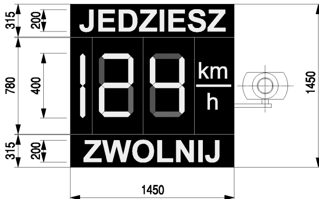
Rys. 13.6.1. Przykładowy wyświetlacz prędkości rzeczywistej z detektorem radarowym
