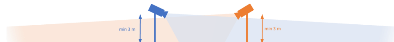
Rys. 2.2 Sposób instalacji kamer - widok z boku
